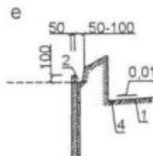
а — «переливной борт», не выступающий над уровнем воды; б — то же, со ступенями для выхода из воды в специализированных ваннах для прыжков в воду; в — борт с отдельным отводом воды: из ванны — на очистку, с обходных дорожек — в канализацию; г — борт, выступающий над уровнем воды с переливным желобом; д — то же, для детских ванн с заглубленной обходной дорожкой; е — то же, для терапевтических занятий инвалидов с недостатками зрения;
