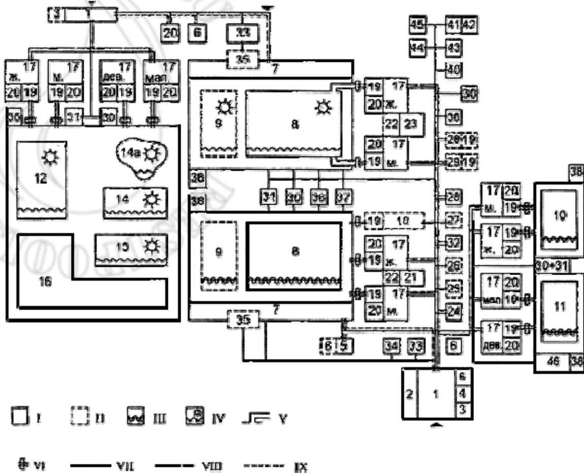
I — помещения и сооружения основного состава; II — помещения и сооружения дополнительного состава; III — крытая ванна; IV — открытая ванна; V — вылив; VI — проходной вешной душ; VII — функциональная связь; VIII — движение занимающихся; IX — движение зрителей
