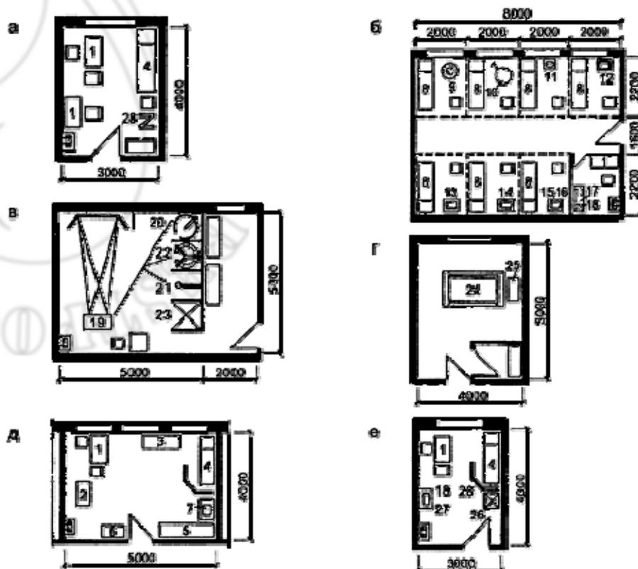
*a* — кабинет врача (заведующего центром); *б* — кабинет электро- и светолечения; *в* — душевой зал; *г* — индивидуальный душ-массаж; *д* — кабинет для проведения тестов с физической нагрузкой; *е* — физиокабинет;
