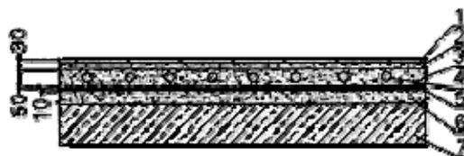
*1* — деревянная планка; *2* — цементная стяжка; *3* — слой песка; *4* — обрезающие трубы; *5* — гидронепроницаемая; *6* — цементная стяжка; *7* — плита перекрытия
