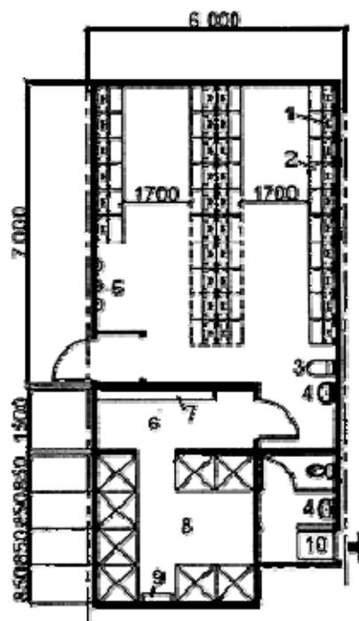
1 — индивидуальное закрытое шкаф; 2 — скамья для переодевания; 3 — скамья для ног; 4 — умывальник; 5 — сушилка для волос; 6 — преддушевая; 7 — вешалка для полотенец; 8 — душевая; 9 — скамья для сидения; 10 — проемной душ
