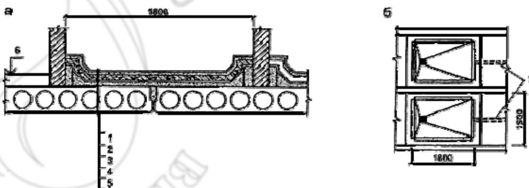
а — разрез; б — план; 1 — керамическая плитка; 2 — армированная железобетонная стена; 3 — четыре слоя гидроизоляции на мастике; 4 — цементная стяжка; 5 — плита перекрытия; б — уровень пола; 7 — трубы
