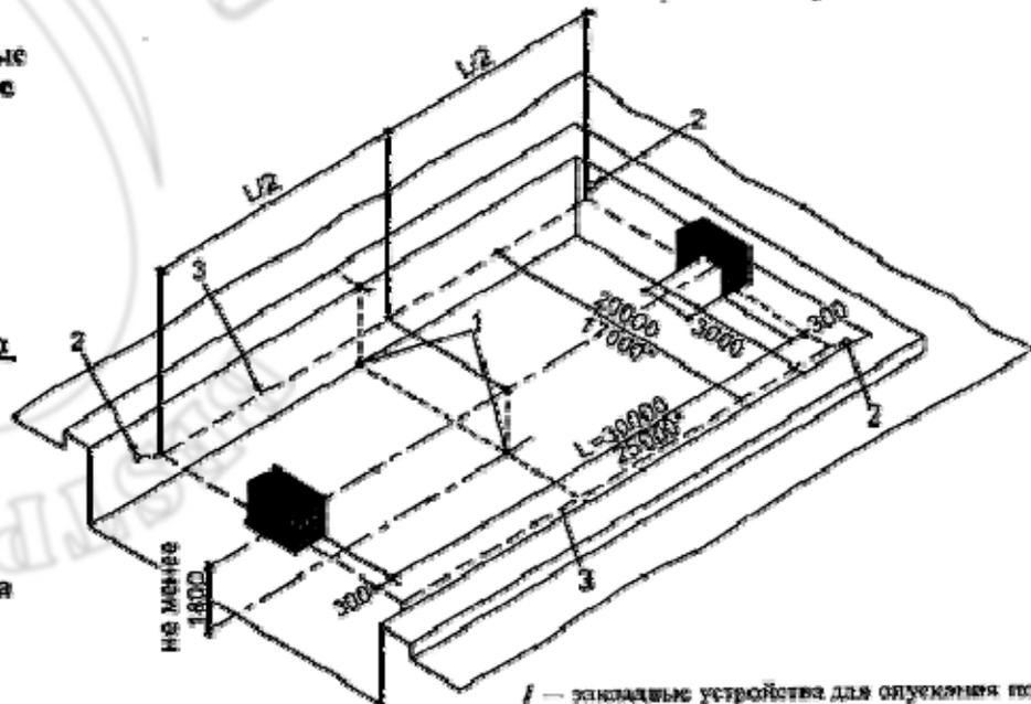
1 — закладные устройства для опускания поплавка под мяч на дно; 2 — крюки в бортике для крепления плавающей разметки границы поля; 3 — граница игрового поля
