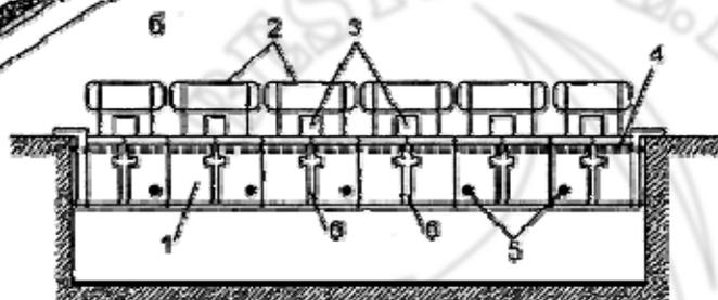
а — общий вид плавающей перегородки, отделяющей часть бассейна; б — поперечный разрез бассейна с плавающей перегородкой
